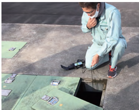
污水処理施設で硫化水素濃度を測定(白石町須古地区)
